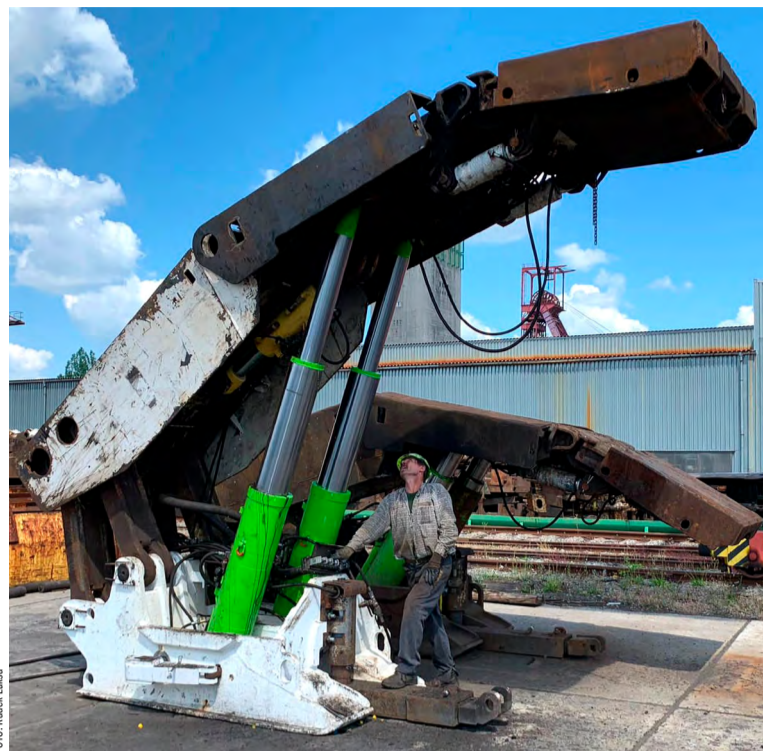
Secke s modernizovanými stojkami při povrchové kontrole.
