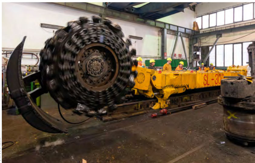
Kombajn v dílně při přejímce po opravě.
