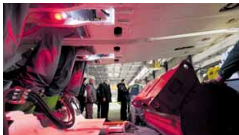
Ciekawa innowacja: W razie nieprawidłowości w sekcjach lampy zaczynają świecić na czerwono.
