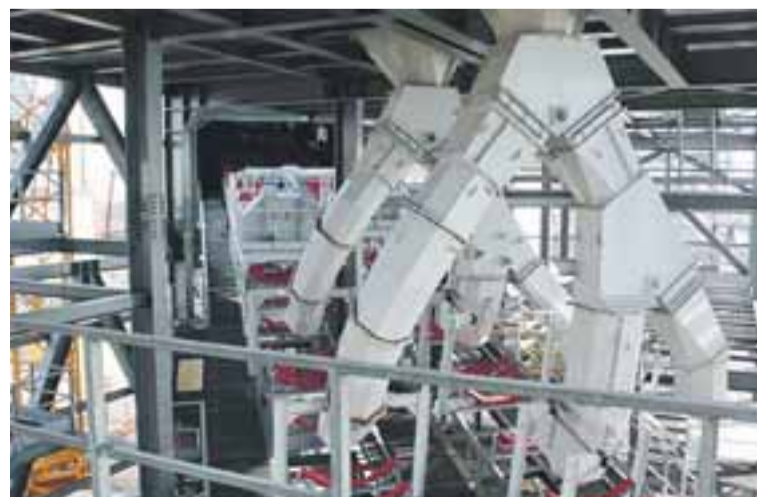
Přesypy mezi jednotlivými technologickými linkami pásové dopravníky TOWER T2.
