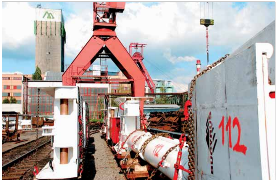
Jednotlivé díly důlních sekcí od firmy Bucyrus připravené loni na podzim k přepravě do podzemí Dolu Darkov. Dnes už jede těžební komplex naplno.
