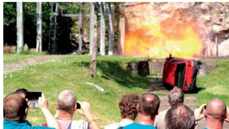
Nejpůsobivější ukázka – výbuch devítiprocentní koncentrace metanu.
