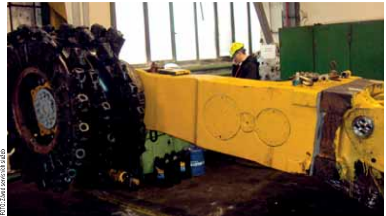
Dobývací kombajn SL 300 v mechanické dílně SC na Důlním závodě 2 – Sever.
