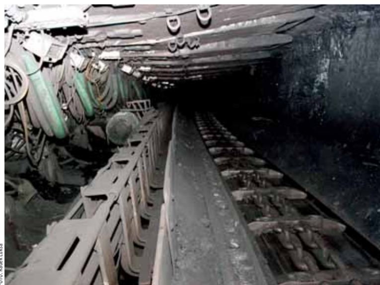
Dobývací komplex se sekcemi středního POPu.
