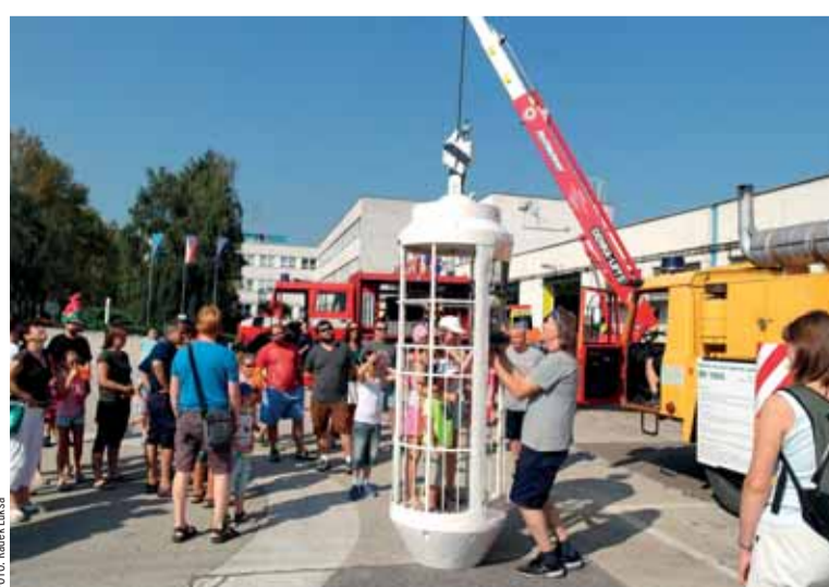
Mobilní havarijní dopravní zařízení ZH 1500 pro fárání do více než kilometrových hloubek.
