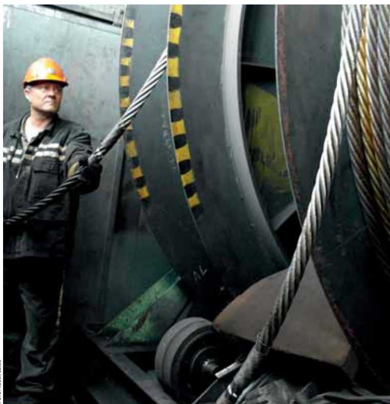
Takzvaná cívkárna pod staříčským skipem, kde údržbář důlní dopravy chystá nová lana.
