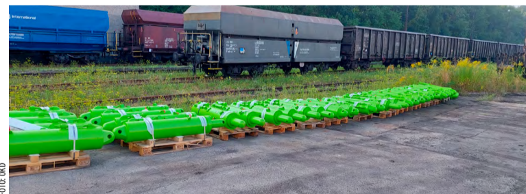
Nové stojky na nádvoří šachty.
